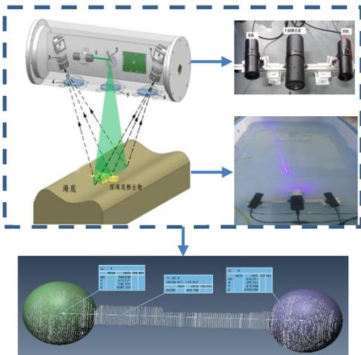
激光高速线扫描3D生物测量系统
