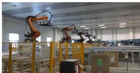
机器人码垛与拆垛系统
