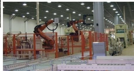
机器人烟包自动解包生产线
