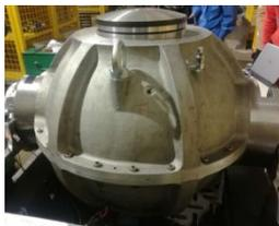
船用减摇陀螺用高速电机及控制器
