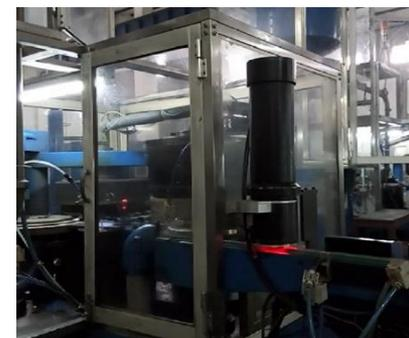
智能皇冠盖高速视觉检测产线
