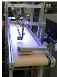
基于图像处理的汽车座椅零件产品质量检测系统
