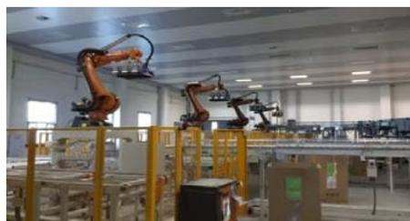
机器人码垛与拆垛系统
