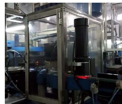
智能皇冠盖高速视觉检测产线
