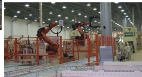
机器人烟包自动解包生产线
