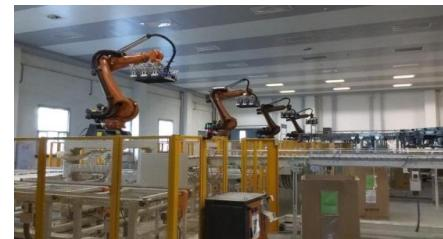
机器人码垛与拆垛系统
