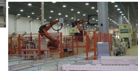
机器人烟包自动解包生产线
